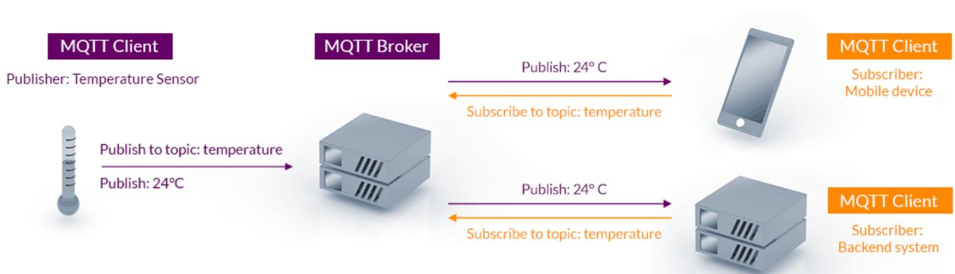
In der MQTT Architektur werden Daten von einem Client zu einem Server (*Broker*) geschickt (*published*). Dieser puffert die Pakete für eine gewisse Zeit.
