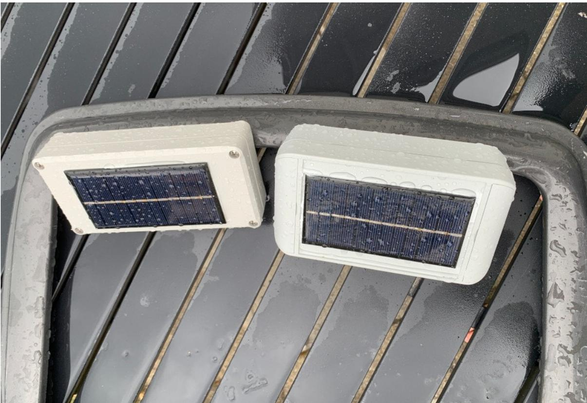
Der erste Schritt des Projekts ist es einen Personenzähler Prototyp zu entwickeln, der den Witterungen auf dem Berg widersteht und über Solar mit Strom versorgt wird. Unser bisheriger Prototyp basiert auf dem [open source ESP32-Paxcounter](#), den wir für unsere Anwendung angepasst haben. Die Daten werden per LoRa-WAN an das ["The Things Network"](#) gesendet. Von dort greifen wir sie ab, speichern sie in einer Datenbank und erstellen mit den gesammelten Daten eine grafische Auswertung.
