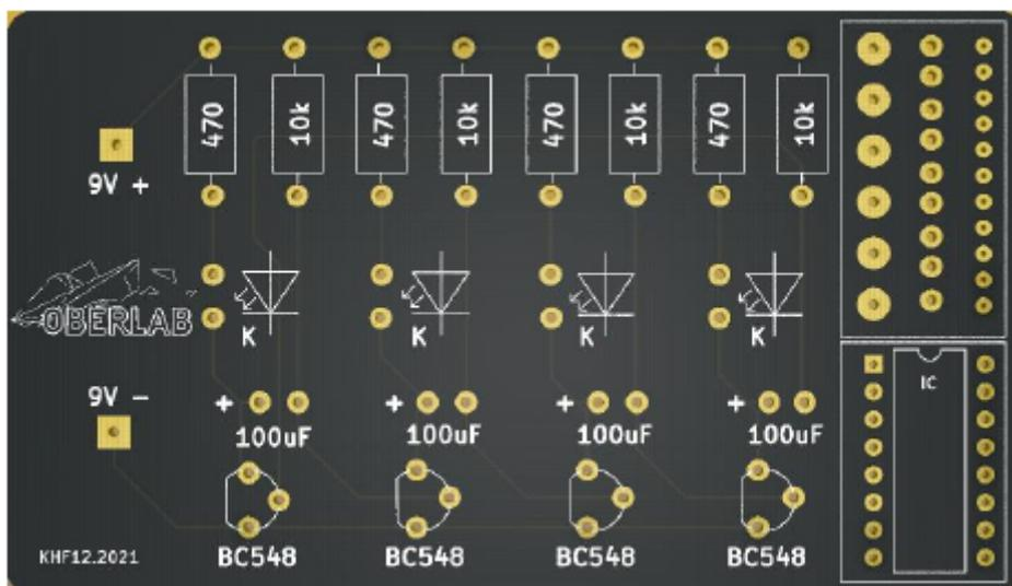
Eine einfache Platine, bei der man zuerst das Lötten üben kann (rechte Seite), bevor man die Komponenten lötet. Final blinken 4 LEDs.
