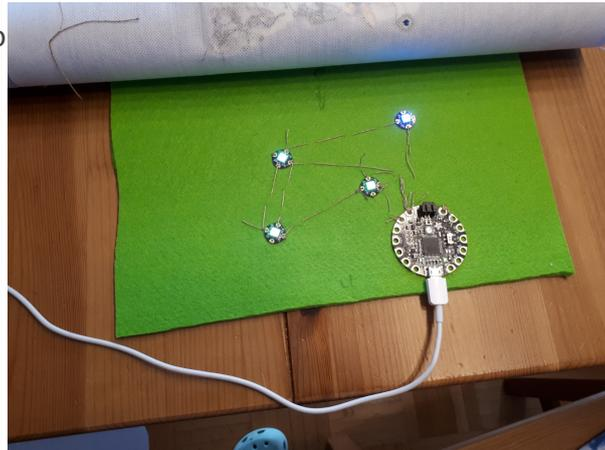
Das ist eine Tasche, die mit einem Motiv von Pfaff bestickt wurde. Zusätzlich wurden runde Knopflöcher gestickt. Hinter der Stickerei befindet sich eine Filzplatte die mit Sewable LEDs, leitendem Garn und einem Adaflora Microkontroller zum Leuchten erweckt wurde.
